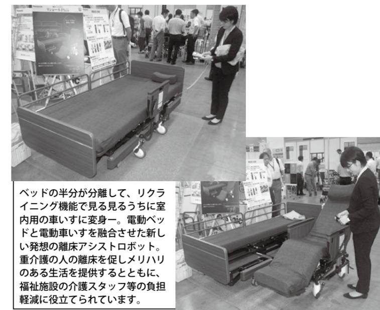
ベッドの半分が分離して、リクライニング機能で見る見るうちに室内用の車いすに変身。電動ベッドと電動車いすを融合させた新しい発想の離床アシストロボット。重介護の人の離床を促しメリハリのある生活を提供するとともに、福祉施設の介護スタッフ等の負担軽減に役立てられています。
